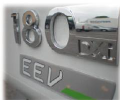
Les châssis porteurs seront Euro 5 (dans l'attente d'Euro 6 en 2014) complétés de l'option EEV (Entranced Environmentally Friendly Véhicule) qui réduit encore les émissions de fumées et de particules ainsi que le niveau sonore. Pour nos carrosseries, nous avons sélectionné des panneaux en nid d'abeille, des toits isolés, des planchers en bois dur, des lisses composites moins sonores, le tout monté sur des joints en mousse ou des mastics isolants.
